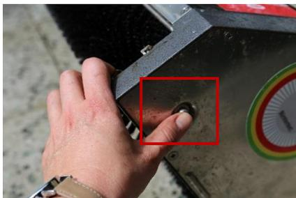
Die Bürsten werden mittels einer Metallstange im Gehäuse gehalten.
