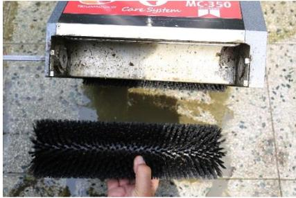
Bürste aus dem Gehäuse entfernen. Auf der Rückseite des Gerätes den Vorgang mit der 2. Bürste wiederholen.
